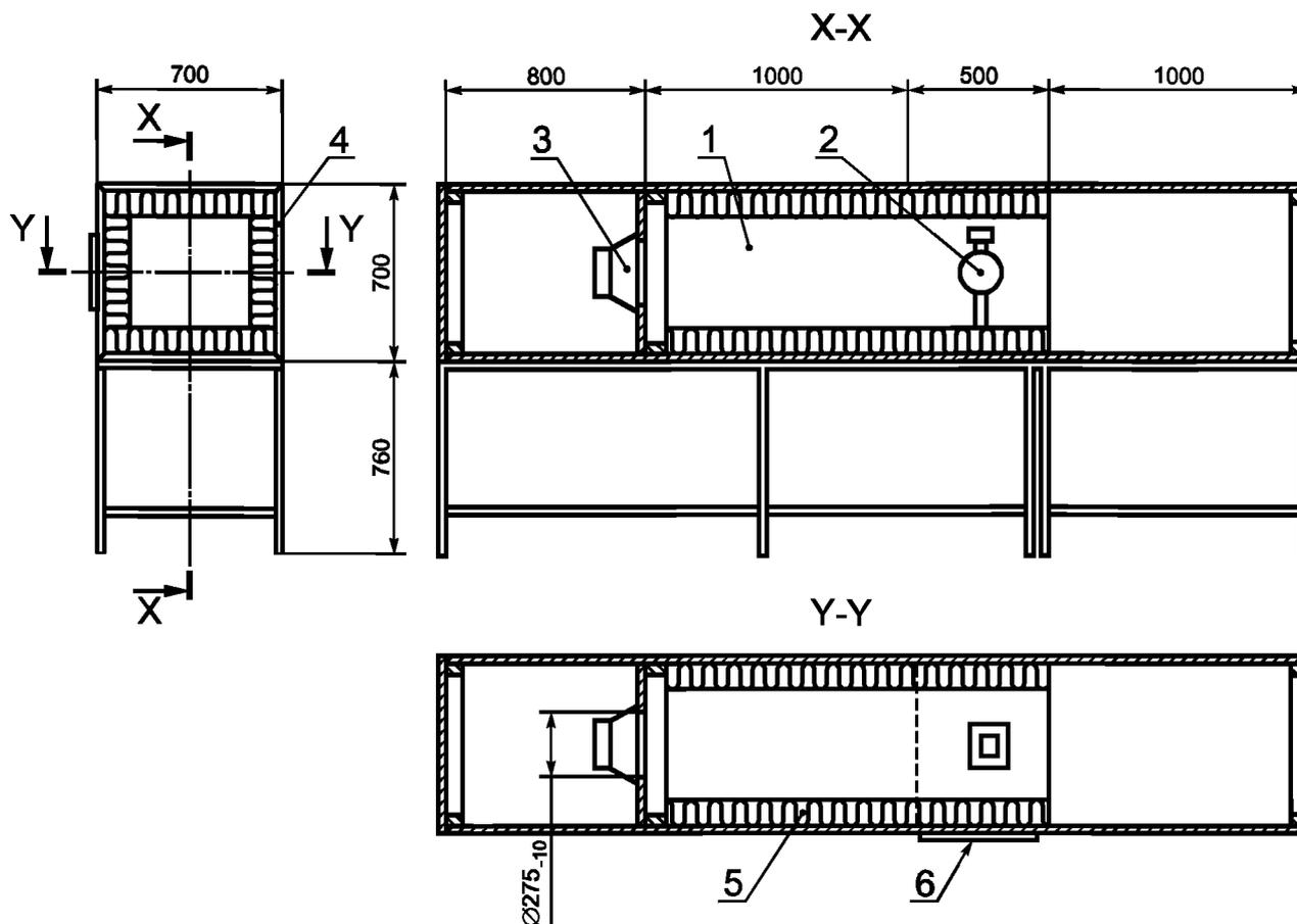
1 — акустический тоннель; 2 — устройство для установки образцов; 3 — динамик;
