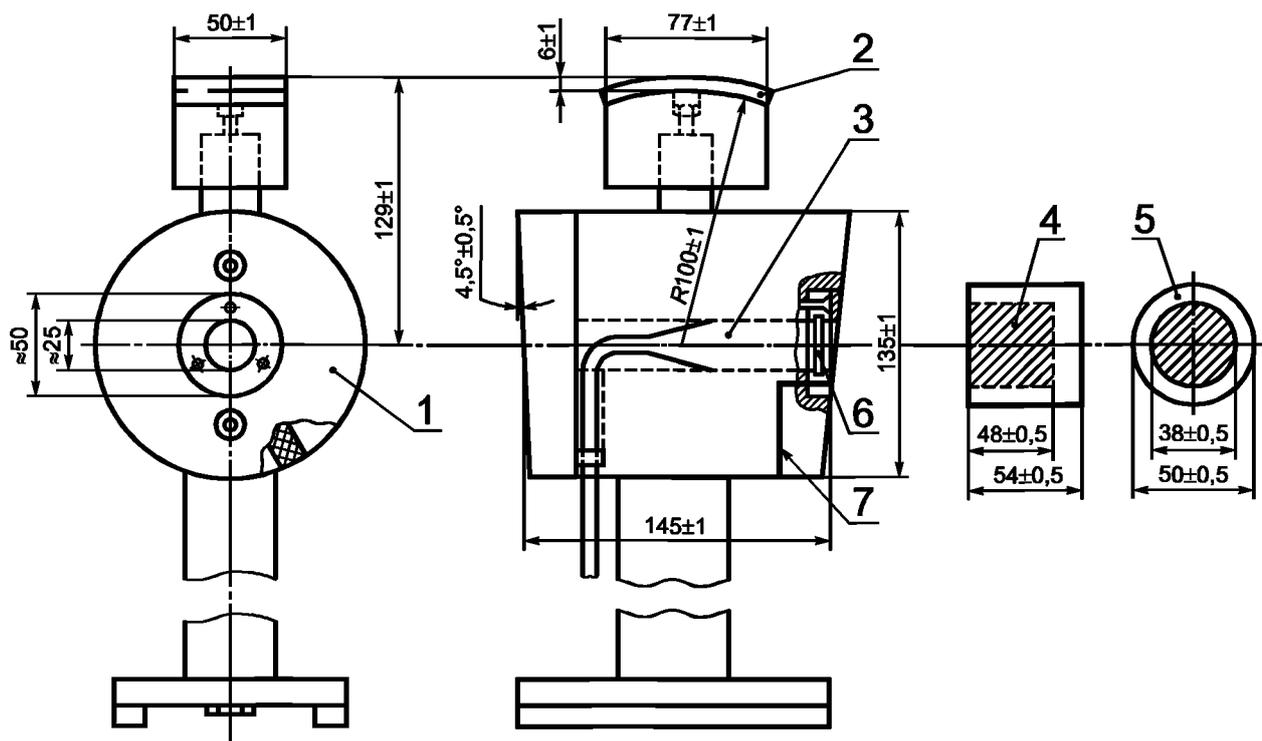
1 — корпус устройства; 2 — резиновый буртик; 3 — предварительный усилитель с микрофоном;
