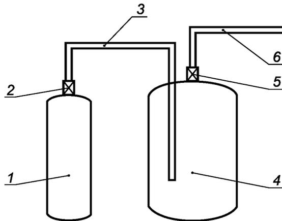
1 — баллон для хранения газа; 2 — ЗПУ; 3 — трубопровод подачи газа; 4 — емкость для хранения порошка;
